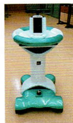
センサで人の姿勢の変化や転倒を読み取り、通報し、人に追従したり、スマホとキネクトカメラで対話もできる万能見守りロボット
